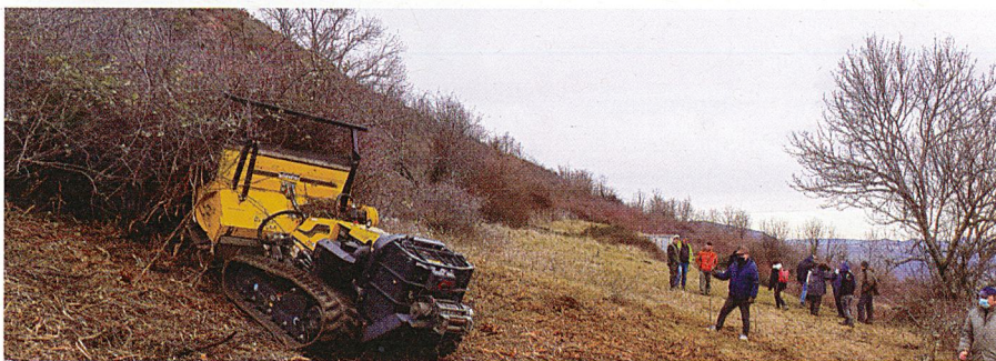
Nettoyage d'un terrain très embroussaillé au moyen d'un tracteur débroussaillieur télécommandé
